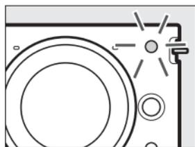
**Modo de controlo remoto:** Aponte o ML-L3 ao receptor de infravermelhos na câmara (📖 2) e pressione o botão de disparo do obturador do ML-L3 (posicione-se a uma distância de 5 m ou menos). No modo de atraso remoto, a luz do auto-temporizador acenderá por cerca de dois segundos antes de o obturador ser disparado. No modo remoto de resposta rápida, a luz do auto-temporizador piscará depois de o obturador ter sido disparado.
