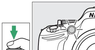
**Modo de controlo remoto:** De uma distância de 5 m ou menos, aponte o transmissor no ML-L3 a um qualquer receptor de infravermelhos na câmara (☐ 1, 2) e prima o botão de disparo do obturador do ML-L3. *No modo de atraso remoto*, a luz do auto-temporizador irá acender durante cerca de dois segundos antes do obturador ser solto. *No modo remoto de resposta rápida*, a luz do auto-temporizador piscará depois de o obturador ter sido disparado.
