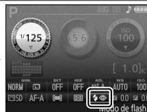
Ajuste a compensação do flash (modo **P, S, A** ou **M**; ☐ 68).
