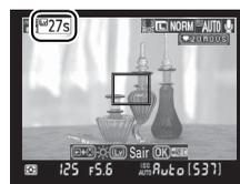
Para reduzir o efeito de tremido quando usar um tripé, escolha **Ligado** na Definição personalizada d10 (**Modo de atraso à exposição**).
