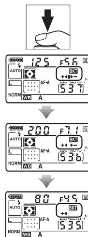
Enquanto o bracketing estiver activado, será apresentado um indicador de progressão do bracketing no painel de controlo. O segmento ■ desaparecerá do indicador quando for tirada a fotografia inalterada, o indicador ►- quando for tirada a fotografia com o incremento negativo, e o indicador +◀ quando for tirada a fotografia com o incremento positivo.
