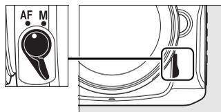
Com objectivas que disponham de selecção A-M, seleccione **A** quando usar focagem automática. Com objectivas que suportem M/A (focagem automática com prioridade manual), seleccione **M/A**. Se a objectiva não suportar focagem automática ou se a câmara for incapaz de focar usando focagem automática, use a focagem manual (pág. 59).
