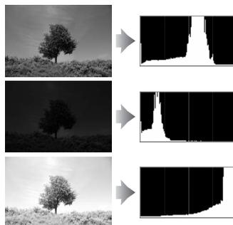
Ao aumentar a compensação da exposição, a distribuição de tons é deslocada para a direita, ao passo que ao reduzir a compensação da exposição, a distribuição de tons é deslocada para a esquerda. Os histogramas podem dar uma ideia geral da exposição global em situações em que a iluminação ambiente muito forte dificulta a visualização das fotografias no monitor.
