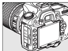
Para remover a tampa, segure a câmara com firmeza e puxe a parte inferior da tampa para fora com cuidado, conforme ilustrado à direita.
